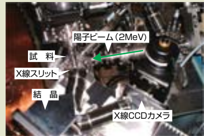
高分解能の検出器で微量元素の化学形態を分析 特殊な結晶でX線を波長ごとに異なる角度に回折させて測定し、従来より高いエネルギー分解能を得る波長分散型検出器(写真)を研究・開発中。上のグラフは、検出器で捉えた塩素(Cl)化合物標準試料に対するX線の波長スペクトル。塩化ナトリウム(NaCl:大気中の自然海塩粒子を模擬)と塩化アンモニウム(NH 4 Cl:ゴミ焼却場等から排出される塩素により発生する可能性のある人為起源塩素化合物)の微妙な差異を捉えることが可能。この方法により、化合物を同定しようとしている。
