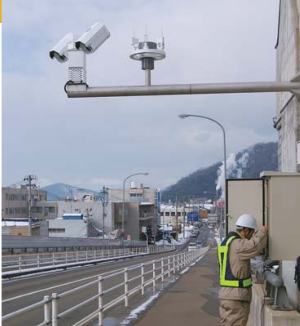
路面性状センサー 原子力機構の特許を応用して開発された、路面性状センサー(写真上部左)。道路上に設置する非接触型で、路面温度や積雪状況などを正確に判定し、データを集積する。
