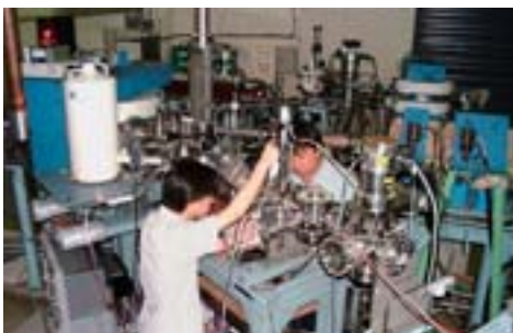
PIXE分析装置 東京工業大学原子炉工学研究所のPIXE分析装置。加速器のビームラインに接続されている。
